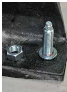
Figura 9c: Posizionare la rondella.
