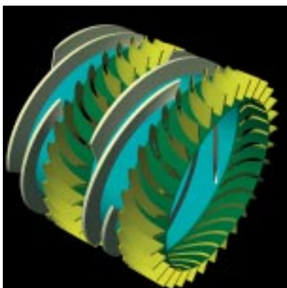
Две последовательные ступени многофазного насоса
