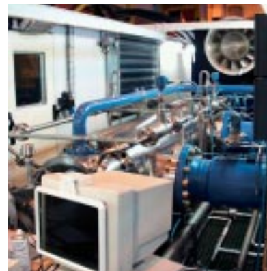
фото: Насос на испытательном стенде Зульцер, с имитацией реальных условий
