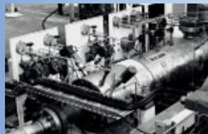
Первый многофазный насос, изготовленный Зульцер Пампс
