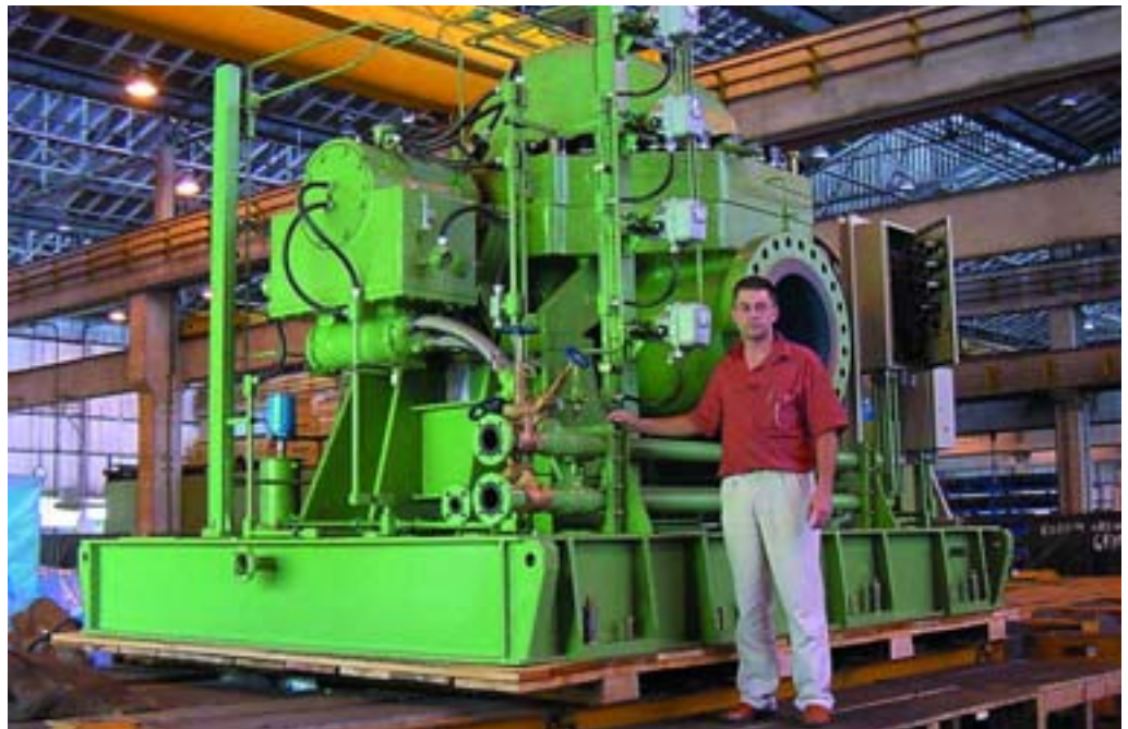
1 Die Pumpe HPDM 600-940-s+s/30 hat eine Leistung von rund 9 MW. Das fertige Gehäuse ist 26 t schwer und besteht aus einem horizontal geteilten Gehäuse, das mit Stiftschrauben zusammengehalten wird.
